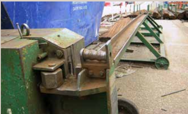
Établi de découpe sur chantier avec cisaille à pied.
