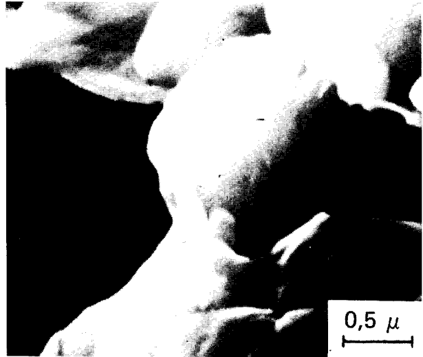
Fig. 26. — Marne de Nice. Sur cette photographie au contraire certains matériaux montrent des agrégats qui sont très voisins du micron en taille. Les vides laissés entre flocons sont alors très petits (voisins de la taille des agrégats) mais très nombreux.
