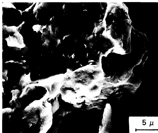
Fig. 24. — Marne de Nice. Peu ou pas de phyllites extérieures associées au flocon.
