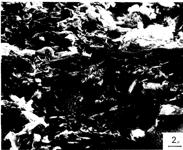
Fig. 17. — Le matériau présente une texture orientée amygdalaire.
