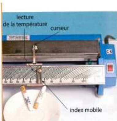
Fig. 6 Détermination d'une température de fusion à l'aide d'un banc Kofler.
