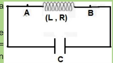
a- Établir l'équation différentielle à laquelle obéit la charge du condensateur q.
