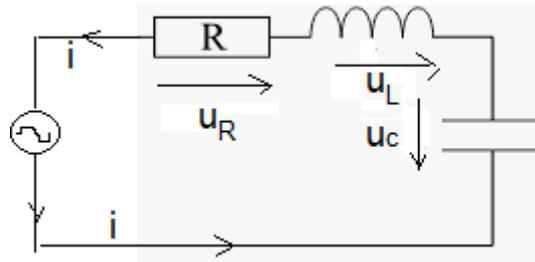
$$u_C + u_L + u_R = 0 \rightarrow \frac{q}{C} + L \cdot \frac{di}{dt} + Ri = 0 \text{ avec } i = \frac{dq}{dt}$$
