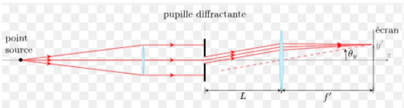
La **diffraction de Fraunhofer** ou diffraction à l'infini est un cas particulier très important où le plan d'observation est situé loin de l'objet diffractant, celui-ci étant éclairé par une onde plane (source ponctuelle à l'infini) et défini par son facteur de transmission  $t(X, Y)$ .
