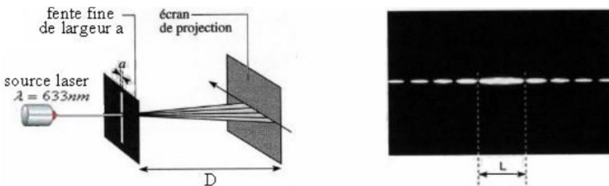
Sur l'écran de projection situé à une distance  $D$  de la fente, on observe une tâche centrale plus large entouré de part et d'autres par des tâches secondaires moins larges et moins brillantes.
