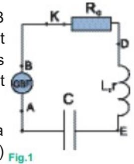
1°) a) Préciser parmi les points A et B du circuit celui auquel on doit relier la masse du GBF afin de visualiser simultanément la tension d'alimentation  $u(t)$  et la tension  $u_{Ro}$  aux bornes du résistor, sur l'écran d'un oscilloscope bicourbe.
