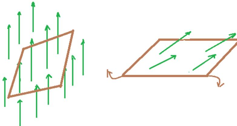
On fait tourner la boucle, l'angle entre le champ magnétique et la normale à la surface varie. On augmente l'angle et le flux augmente.
