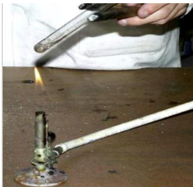
Chauffage du tube à essai sur un bec Bunsen.
