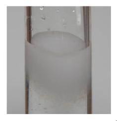
Après ajout de la Soude dans la solution de Chlorure de Zinc (II), un précipité blanc d'hydroxyde de Zinc II se forme, ce qui confirme la présence d'ions Zinc II dans la solution initiale.
