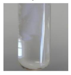
Après ajout du Nitrate d'Argent dans la solution de Chlorure de Sodium, un précipité blanc de Chlorure d'Argent se forme, ce qui confirme la présence d'ions Chlorure dans la solution initiale.
