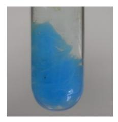
Après ajout de la Soude dans la solution de Sulfate de Cuivre (II), un précipité d'hydroxyde de Cuivre se forme, ce qui confirme la présence d'ions Cuivre II dans la solution initiale.
