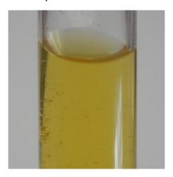
Avant l'ajout de la Soude, la solution de sulfate de Fer (III) est légèrement jaunâtre
