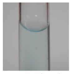
Avant l'ajout de la Soude, la solution de sulfate de Cuivre (II) est de couleur bleutée
