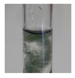
Après ajout de la Soude dans la solution de Sulfate de Fer (II), un précipité d'hydroxyde de Fer se forme, ce qui confirme la présence d'ions Fer II dans la solution initiale.
