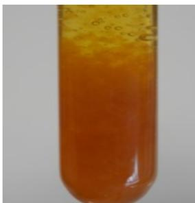
Après ajout de la Soude dans la solution de Sulfate de Fer (III), un précipité jaune d'hydroxyde de Fer III se forme, ce qui confirme la présence d'ions Fer III dans la solution initiale.
