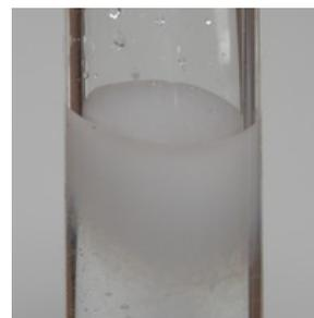
Après ajout de la Soude dans la solution de Chlorure de Zinc (II), un précipité blanc d'hydroxyde de Zinc II se forme, ce qui confirme la présence d'ions Zinc II dans la solution initiale.
