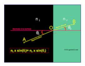
La loi de Snell (Snell Descartes en France) permet de calculer la direction d'un rayon lumineux incident puis réfracté par un milieu optique, si l'on connaît l'indice de réfraction des milieux traversés, et l'angle du rayon incident avec la normale (perpendiculaire) à la surface au point rencontré par le rayon.
