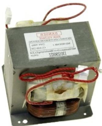
Le transformateur haute tension amplifie le courant électrique pour faire fonctionner le magnétron. Une extrémité de cette pièce est reliée directement à la masse de l'appareil. Si le transformateur est défectueux, l'appareil fera du bruit et peut faire sauter le disjoncteur ou un fusible. De ce fait, votre micro-ondes ne pourra pas fonctionner. Avant de vérifier cette pièce, respectez bien les consignes de sécurité énoncées en début d'article, vous risquez l'électrocution.
