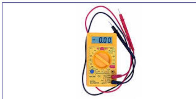
Ouvrez le premier porte-**fusible** basculant et sortez le **fusible** qui se trouve à l'intérieur. Placez une pointe du multimètre à chaque extrémité du disjoncteur. **Si** l'écran affiche « 1 », alors le **fusible** est **grillé**. **Si** l'écran affiche « 0 », le **fusible** est en état de marche.
