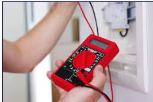
Placez les pointes de contact du **multimètre** contre les deux extrémités du **fusible**. Si l'écran affiche la valeur 0 ou si l'appareil émet un son, alors votre **fusible** fonctionne. Si l'écran affiche la valeur 1 ou si l'appareil n'émet aucun son, alors il va vous falloir changer votre **fusible**. 11 janv. 2019
