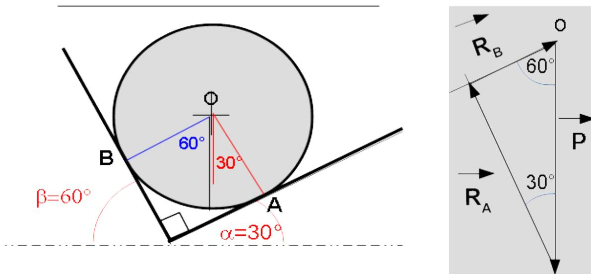
En l'absence de frottements, les directions des forces  $\vec{R}_A$  et  $\vec{R}_B$  sont normales aux surfaces de contact.
