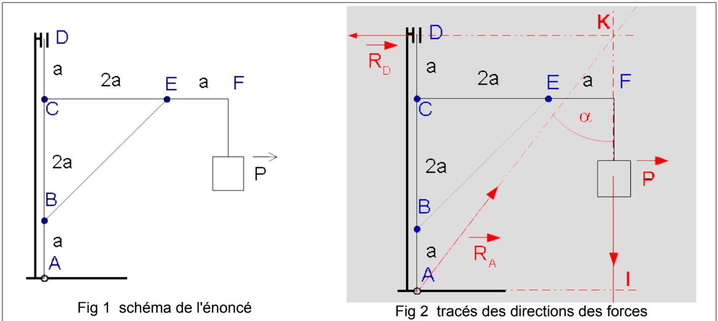
Les directions de  $\vec{P}$  (verticale) et de  $\vec{R}_D$  (horizontale) se coupent en K. Les directions des forces étant concourantes, la droite d'action de  $\vec{R}_A$  passe aussi par K. Ceci permet d'évaluer l'angle  $\alpha$  entre la direction de  $\vec{R}_A$  et la verticale.
