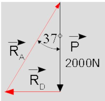
A partir d'un point origine, tracer le vecteur force  $\vec{P}$  dont les caractéristiques sont toutes connues. Tracer la direction de  $\vec{R}_D$  horizontale passant par l'extrémité de  $\vec{P}$ . Tracer la direction de  $\vec{R}_A$  inclinée de  $37^\circ$  et passant par l'origine de  $\vec{P}$ . Le point d'intersection des deux directions précédentes donne le point de fermeture du triangle des forces placées bout à bout. Un choix d'échelle permet d'obtenir les intensités graphiquement.
