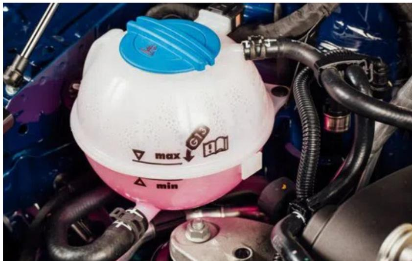
Votre circuit de refroidissement dispose d'un réservoir que l'on appelle **vase d'expansion**. C'est lui qui contient votre **liquide de refroidissement**. C'est aussi le point d'entrée lorsque vous faites l'appoint ou que vous **changez votre liquide de refroidissement**.
