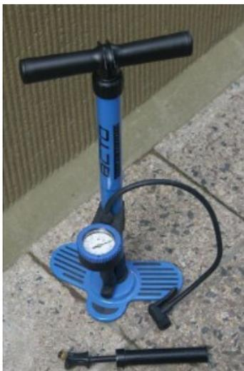
Lors de fonctionnement d'une pompe à vélo, l'air est comprimé avant d'être éjecté dans le pneu.
