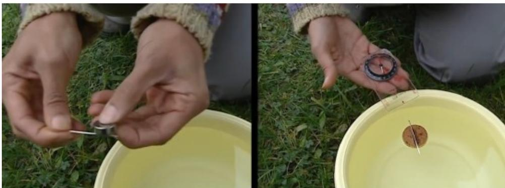
Quel que soit l'emplacement de la bassine, l'aiguille s'oriente suivant l'axe Nord-Sud. En effet, l'aiguille est soumise au champ magnétique de la Terre. Cette expérience montre que la Terre se comporte comme un gigantesque aimant.
