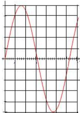
$U_m$  (tension de crête) est la valeur maximale de la tension fournie par le générateur. Entre les instants  $t_1$  et  $t_2$ , la tension est positive et entre les instants  $t_2$  et  $t_3$ , la tension est négative.
