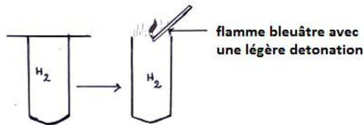
On obtient un gaz incolore et inodore qui, à l'approche d'une flamme, brûle après une légère détonation: c'est le **dihydrogène**.
