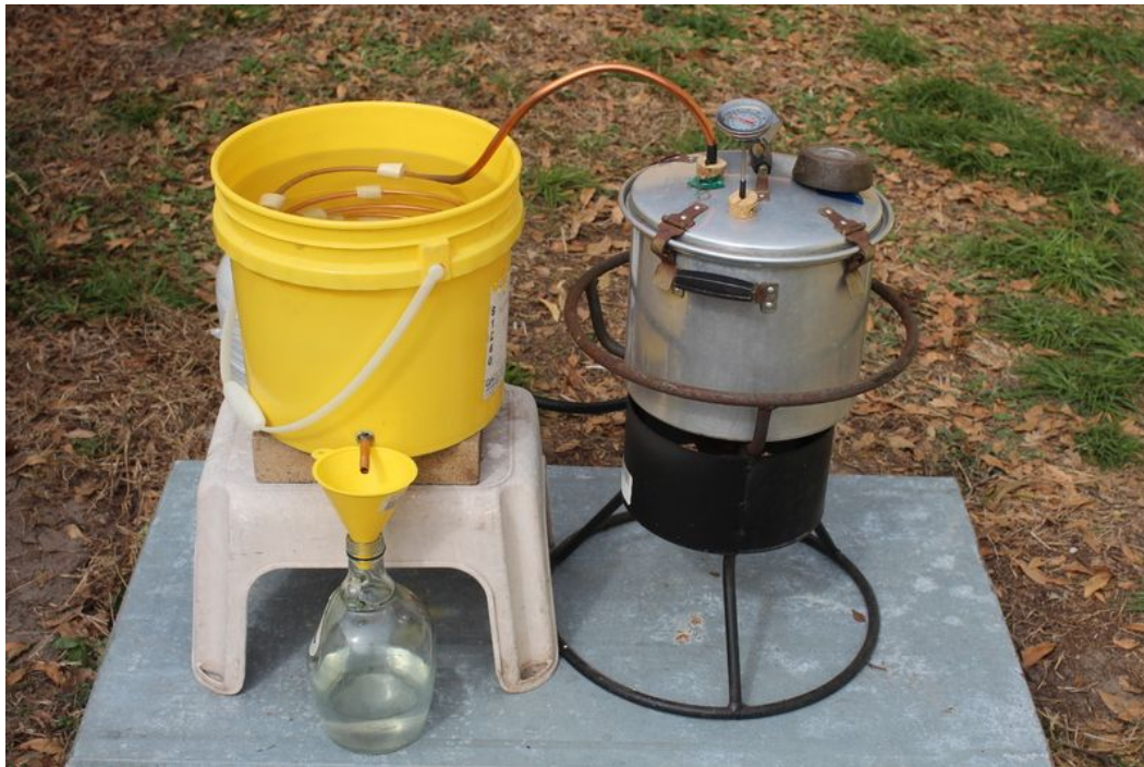
Les alambics à bain-marie et injection de vapeur Principe de fonctionnement
