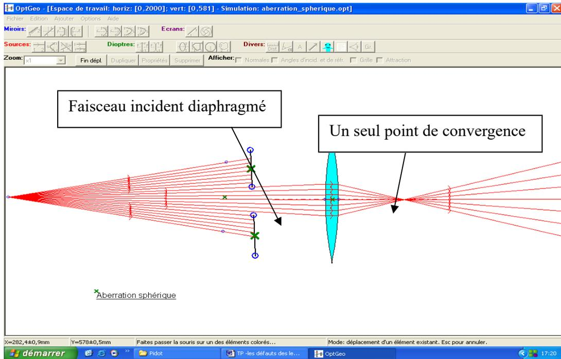
La méthode la plus simple pour améliorer la netteté de l'image est de diaphragmer le faisceau. Inconvénient: l'intensité de la lumière est réduite... Il existe des méthodes plus complexes: accoler plusieurs lentilles pour compenser les défauts (objectif d'appareil photo ou microscope ...)
