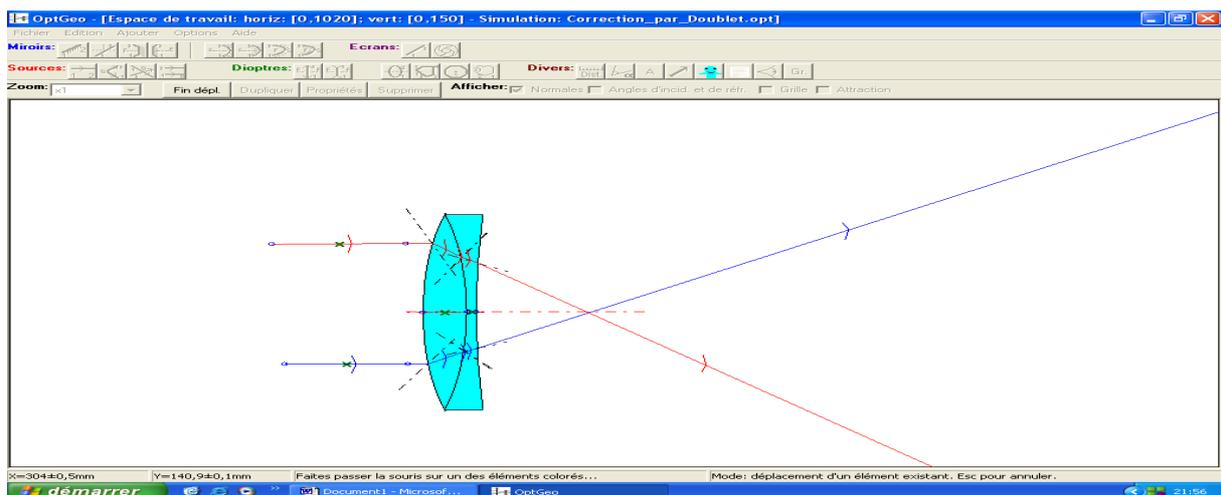
***Ce type de correction est très utilisé dans les objectifs d'appareils photographiques. Une lentille utilisée seule n'est jamais achromatique***
