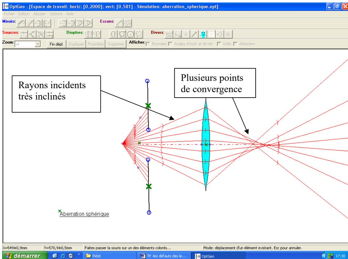
La distance focale n'est donc pas la même suivant les rayons; utilisée avec de tels rayons, la lentille ne peut pas donner une image nette. Ajoutons un diaphragme pour limiter le diamètre du faisceau qui tombe sur la lentille....
