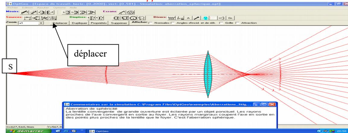
Approcher le point source S de la lentille (bouton «déplacer») et constater l'effet sur les rayons réfractés (v fig suivante)
