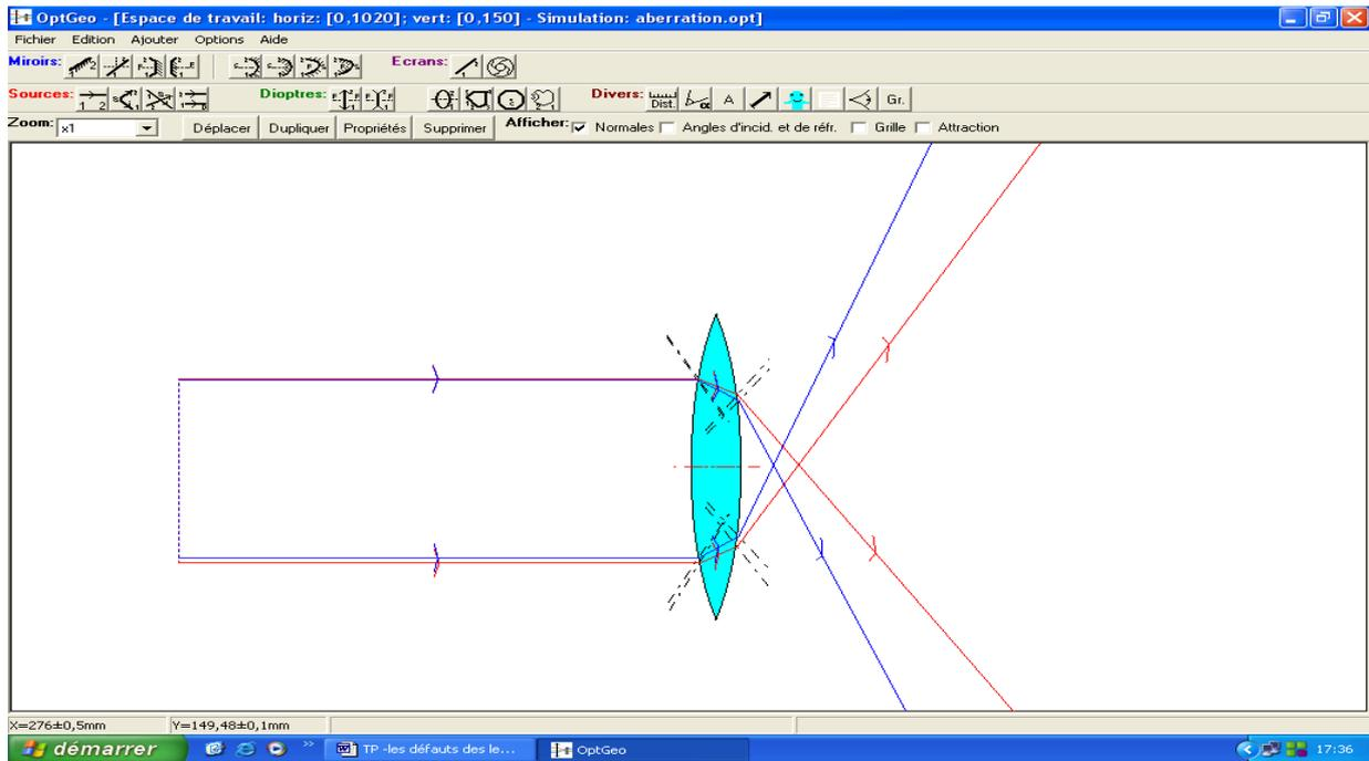
La distance focale de la lentille est différente pour les rayons bleus et rouges. Chaque radiation colorée produit sa propre image. Celle-ci est donc irisée et floue. On pourra éloigner ou rapprocher les rayons incidents de l'axe optique et noter l'influence sur la séparation des rayons bleus et rouges. Elle est plus importante pour des rayons éloignés et fortement inclinés.
