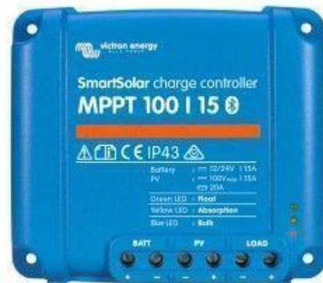
La plupart des régulateurs MPPT modernes permettent d'obtenir des rendements situés entre 92% et 97%. L'emploi d'un régulateur MPPT permet d'obtenir généralement de 20% à 45% de puissance supplémentaire en hiver et de 10% à 15% en saison chaude (par rapport à un régulateur classique). Les gains réels peuvent varier largement en fonction de la météo, de la température, de l'état de charge de la batterie et d'autres facteurs.
