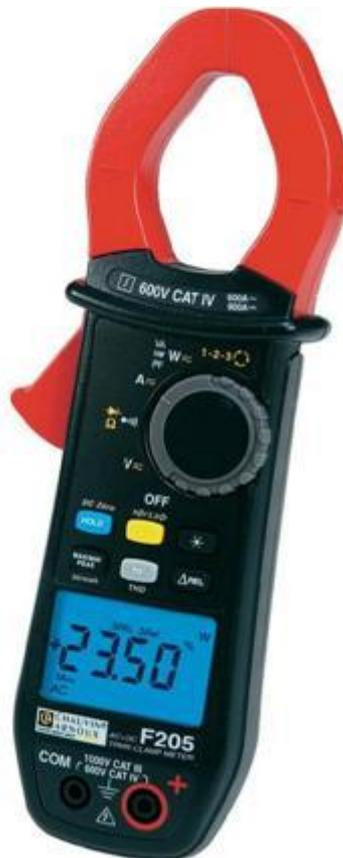
La pince ampèremétrique est très utile pour mesurer les intensités, surtout si elles sont élevées. Certaines permettent aussi de mesurer des tensions et des résistances. Il existe aussi des adaptateurs pince qui s'utilisent avec les cordons des multimètres.
