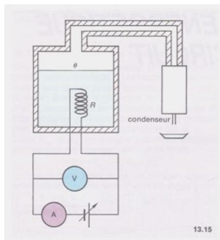
1/ On réalise une première expérience dans les conditions électriques suivantes:  $I_1 = 2,24\text{A}$ ;  $U_1 = 16\text{V}$ . La masse de liquide recueillie au bout d'une minute est de 5,59g. Si on admet que la masse de liquide recueillie représente toute la vapeur produite, calculer la chaleur latente L de vaporisation de ce liquide à  $\theta \text{ °C}$ .
