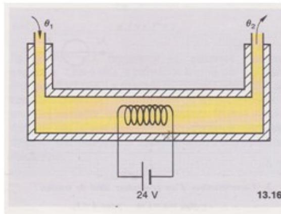
En régime permanent, la température de l'huile entrant dans l'appareil est  $\theta_1 = 20,4^\circ\text{C}$ ; la température de sortie est  $\theta_2 = 24,6^\circ\text{C}$ . Le débit d'huile est de  $\text{.min}^{-1}$ ; la masse volumique de l'huile est égale à  $0,9\text{g.cm}^3$ .
