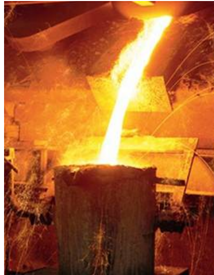
Coulée de fonte en bas du haut-fourneau
