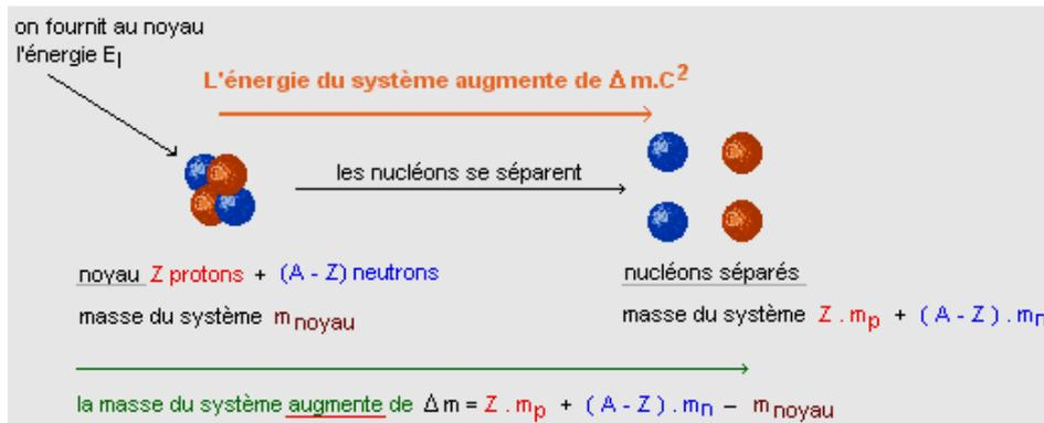
Lorsqu'on brise le noyau, sa masse augmente de  $\Delta m$  et son énergie de  $\Delta m.c^2$ . On en déduit que l'énergie de liaison d'un noyau a pour expression:
