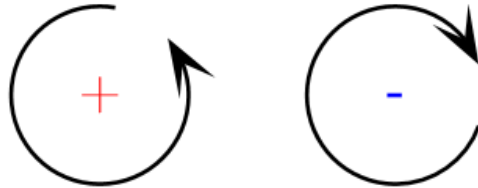
Figure 1.1 – Sens de rotation trigonométrique
