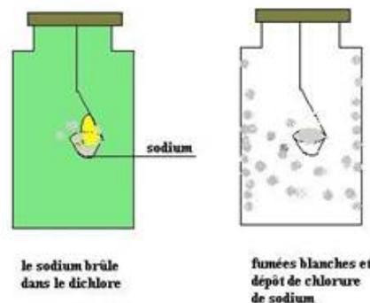
Le métal sodium brûle vivement dans le gaz dichlore avec une flamme jaune caractéristique.
