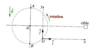
Une fronde est constituée de deux cordelettes inextensibles retenant un projectile de masse M = 100 g, supposé ponctuel. Elle est maniée par le lanceur de façon qu'elle décrive un cercle vertical de centre il et de rayon R, à la vitesse angulaire w constante.
