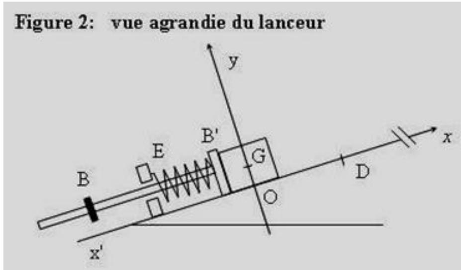
Un manipulateur tire sur la tige et comprime ainsi le ressort jusqu'à ce que le centre d'inertie du palet se trouve au point O. En lâchant la tige, il libère le dispositif qui propulse le palet.
