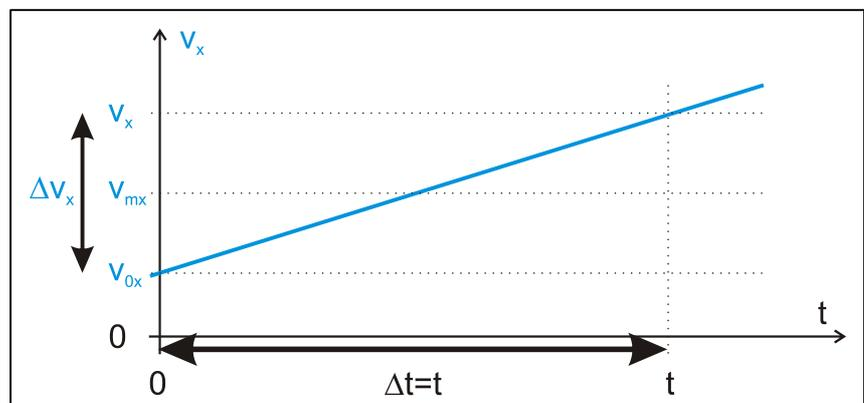
Il vient :  $x = x_0 + v_{mx} \cdot t = x_0 + \left( \frac{v_x + v_{0x}}{2} \right) \cdot t$
