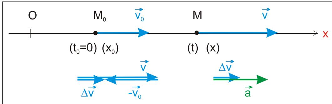
Le vecteur vitesse  $\vec{v}$  varie donc de  $\Delta\vec{v} = \vec{v} - \vec{v}_0$  au cours de l'intervalle de temps  $\Delta t = t - t_0$ .
