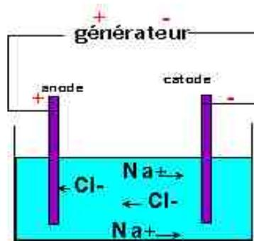
Dans une solution conductrice le courant électrique est dû à une circulation d'ions. Par exemple, l'eau salée, de formule chimique  $(\text{Na}^+, \text{Cl}^-)$  contient des ions chlorure  $\text{Cl}^-$  et des ions sodium  $\text{Na}^+$ . Sous l'action d'une différence de potentiel (pile) ces ions se mettent en mouvement et créent une circulation de courant.
