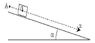
On lâche un mobile autoporteur de masse m=500g depuis un point A d'une table inclinée d'un angle  $\alpha$  par rapport à l'horizontale. (  $g=9.81\,N.k\,g^{-1}$  )
