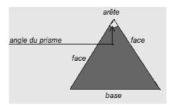
Un rayon de lumière monochromatique subit, à la traversée de chacune des faces du prisme, une réfraction, de sorte qu'il se trouve dévié vers la base du prisme. La déviation dépend de la couleur de la radiation monochromatique utilisée, elle est plus grande pour une radiation violette que pour une radiation rouge. Ce phénomène, appelé dispersion, permet de séparer les radiations de couleurs différentes
