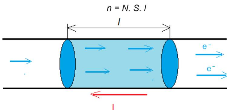
*La portion de fil de longueur  $l$  contient  $N$  électrons qui progressent à la vitesse moyenne  $v$ ; tous ces électrons, y compris les plus éloignés, auront traversé la section d'aire  $S$  au bout d'un temps  $t = l/v$ .*
