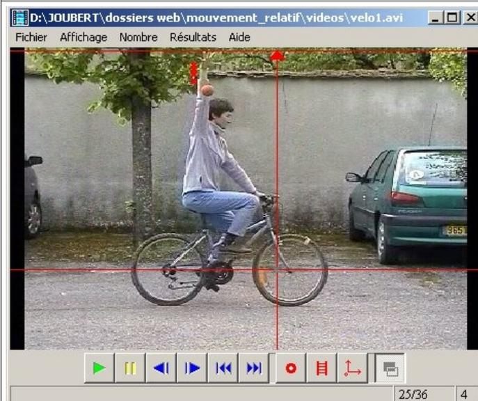
Avant chaque nouveau pointage de la position de la balle, une «souris» s'affiche sur l'écran invitant l'opérateur de la manipulation à ramener l'origine du repère au centre de la roue. (ce qui revient à déplacer le calque)
