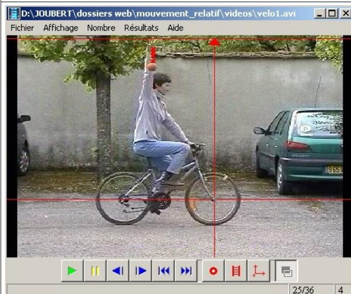
On observe alors les positions successives de la balle en rouge sur le calque se déplaçant avec le vélo. (voir l' image à gauche et la suivante)
