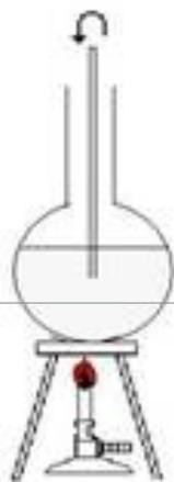
Deux prélèvements sont réalisés toutes les vingt minutes : l'un est soumis, après refroidissement au test de l'eau iodée ; l'autre au test à la liqueur de Fehling bouillante.
