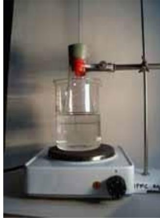
La feuille est décolorée par de l'éthanol bouillant. Un réfrigérant permet d'éviter les vapeurs éthyliques (prévoir un récipient d'eau froide en cas d'ébullition exagérée et utiliser un système de chauffage électrique et non pas à gaz) ;
