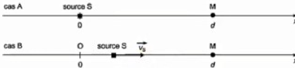
Figure 1. Schéma représentant une source sonore immobile (cas A), puis en mouvement (cas B).
