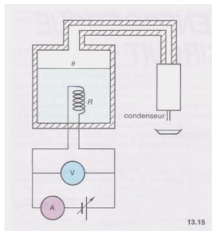
1/ On réalise une première expérience dans les conditions électriques suivantes:  $I_1 = 2,24\text{A}$ ;  $U_1 = 16\text{V}$ . La masse de liquide recueillie au bout d'une minute est de 5,59g. Si on admet que la masse de liquide
