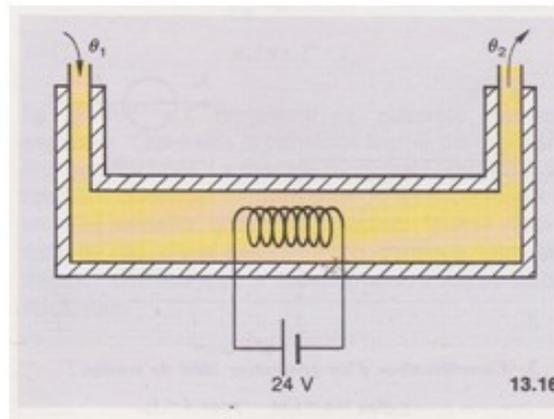
En régime permanent, la température de l'huile entrant dans l'appareil est  $\theta_1 = 20,4^\circ\text{C}$ ; la température de sortie est  $\theta_2 = 24,6^\circ\text{C}$ . Le débit d'huile est de  $\text{.min}^{-1}$ ; la masse volumique de l'huile est égale à  $0,9\text{g.cm}^3$ .
