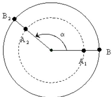
Au cours d'une rotation, plus un point du solide est éloigné de l'axe de rotation, plus la longueur de l'arc qu'il décrit, est grande: les points du solide n'ont pas la même vitesse.
