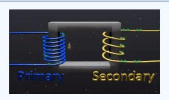
L'énergie est transférée du primaire au secondaire par l'intermédiaire du circuit magnétique que constitue la carcasse du transformateur.
