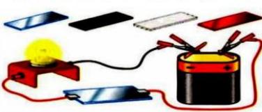
Note dans un tableau le nom du matériau : Bois, aluminium, graphite, fer. Précise l'éclat de l'ampoule.
