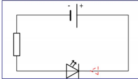
On peut observer que la **DEL reste éteinte** dans le circuit 2 : aucun courant ne circule donc.
