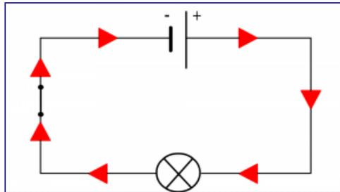
Remarque : On n'indique le **sens du courant** que dans un circuit où le courant électrique circule effectivement. Par exemple on n'indique pas le sens du courant dans un circuit comportant un interrupteur ouvert.
