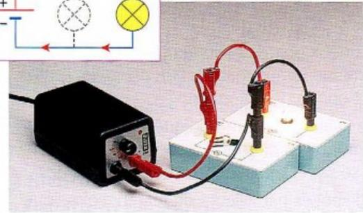
Si une lampe est grillée (ou dévissée), l'autre fonctionne encore car sa boucle est fermée.
