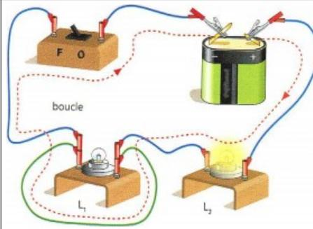
Quand on court-circuite un dipôle ce dernier ne fonctionne plus car tout le courant passe par le fil de court-circuit. Les autres dipôles fonctionnent. Pas de mise en court-circuit du générateur.
