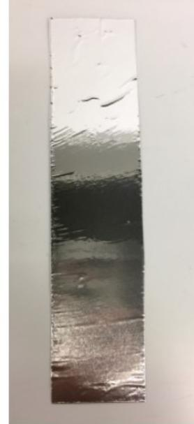
Bilame 2: bilame fabriqué à l'aide du collage d'un film d'aluminium sur une bande de carton
