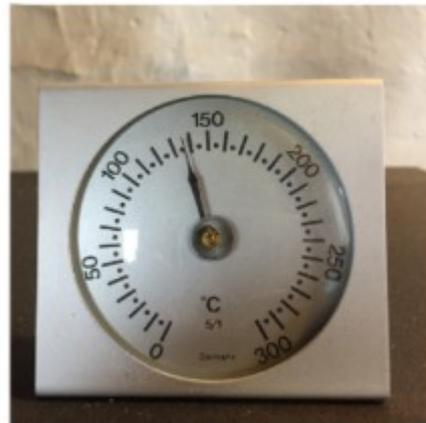
*bilame spiral utilisé comme thermomètre*
