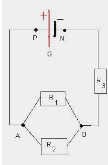
Calculer la tension aux bornes du générateur si l'intensité du courant qui traverse  $R_2$  est 0,3A.
