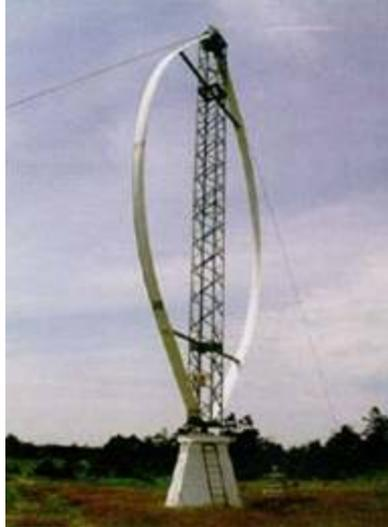
Les éoliennes à axe vertical ne nécessitent pas de système d'orientation par rapport à la direction du vent, mais sont, en général, de conception assez compliquée. Des pales longilignes sont entraînées par un axe massif et vertical.
