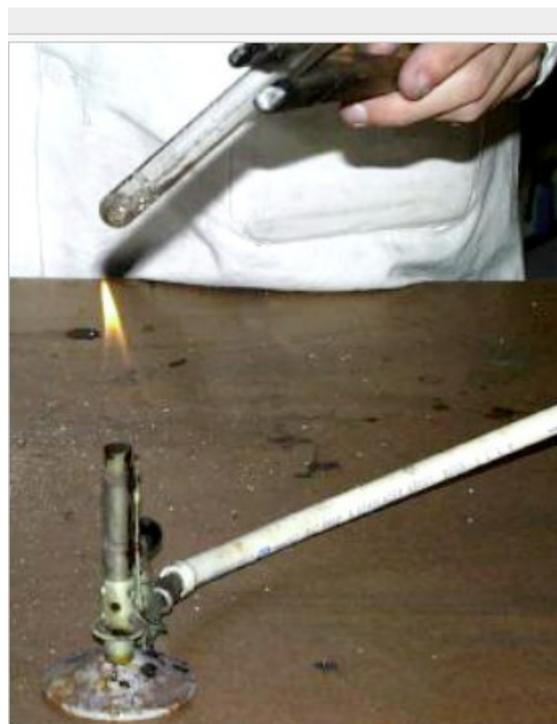
Chauffage du tube à essai sur un bec Bunsen.
