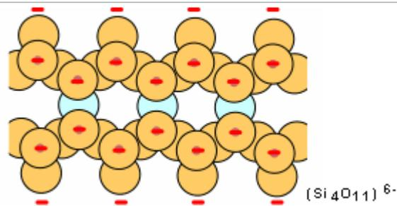
Lorsque des chaînes doubles s'unissent, chaque tétraèdre partage trois oxygènes (en bleu sur le schéma qui suit); la formule générale est  $\text{Si}_4\text{O}_{10}$  avec une charge de -4. On aura une structure en couche.
