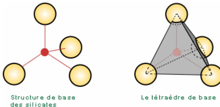
Si on relie les centres des oxygènes, on obtient un volume qui forme un tétraèdre, le **tétraèdre de base** (schéma de droite). Le silicium occupe le centre du tétraèdre. Le calcul des charges électriques montre qu'un tétraèdre est chargé négativement.
