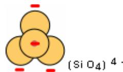
Lorsque chaque tétraèdre partage un oxygène (en blanc sur le schéma qui suit), on obtient une chaîne simple de tétraèdres. Il en résulte que pour chaque tétraèdre deux charges négatives ont été neutralisées et qu'il en reste deux autres à neutraliser (les traits rouges); la structure est chargée à  $-2$ .
